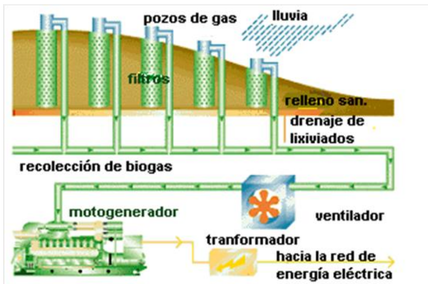
Figura 5 Esquema de producción de energía eléctrica a base de biogás proveniente de relleno sanitario tomada de (Reporte Sobre Biomasa, 2012).
