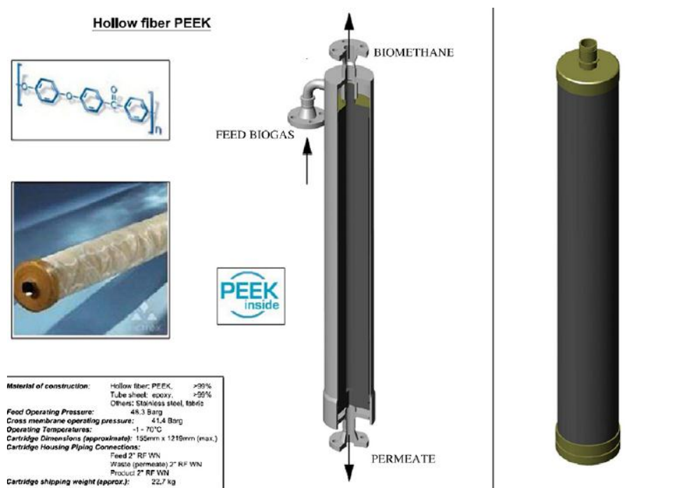
Figura 8 Esquema de membrana para biogás PEEK. (Molino, y otros, 2012)
