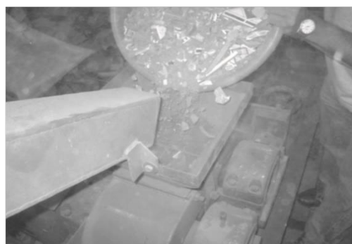
Fotografía 2. Trituración de los escombros en el CIMEX de la Universidad Nacional.
