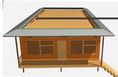
La renovación del aire interior se presenta mediante pequeñas aberturas realizadas en el cielo raso permitiendo el paso del aire caliente.
