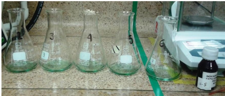
Figura 14 Erlenmeyer con 15 ml de ácido bórico y 3 gotas de indicado mixto
