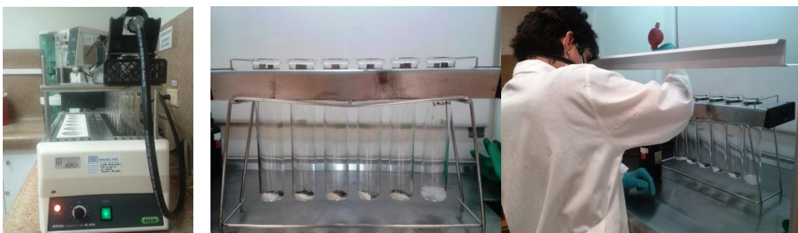
Figura 10 Aplicación de las pastillas Kjeldahl y el ácido sulfúrico en el análisis de nitrógeno total
