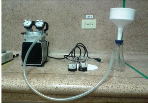
Figura 18 Montaje de la Bomba al vacío, embudo Buchner y el Erlenmeyer para análisis de CE
