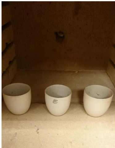
Figura 16 Montaje muestra de lodo residual y capsula en el horno para el análisis de materia orgánica
