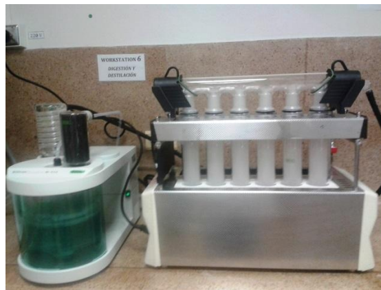
Figura 11 Proceso de digestión en el análisis de nitrógeno total
