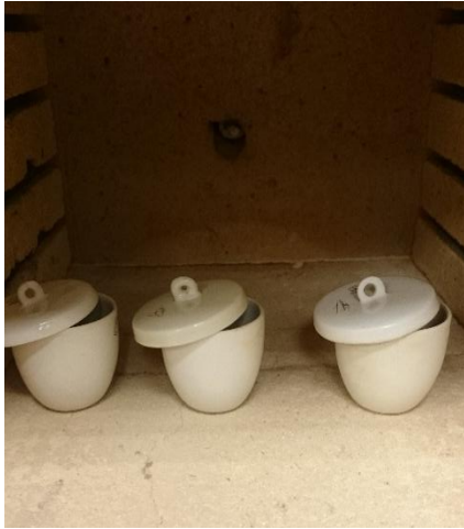
Figura 4 Montaje capsulas con tapa y lodo en el horno para humedad
