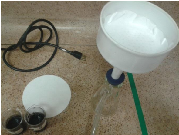
Figura 6 Montaje de filtración de vacío para el análisis de CIC
