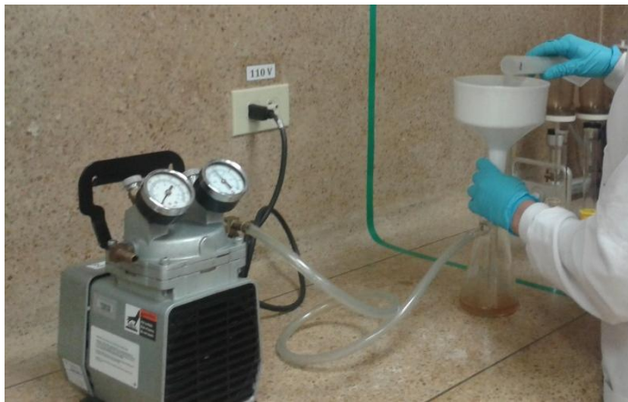
Figura 8 Lavado del lodo con porciones (ml) de acetato de amonio 1M pH 7 para el análisis de CIC.
