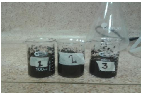
Figura 2. Homogenización de la muestra para la medición de pH
