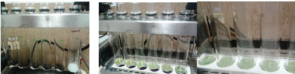
Figura 12 Cambios de color que deben tomar las muestras durante el proceso de digestión en la prueba de nitrógeno total
