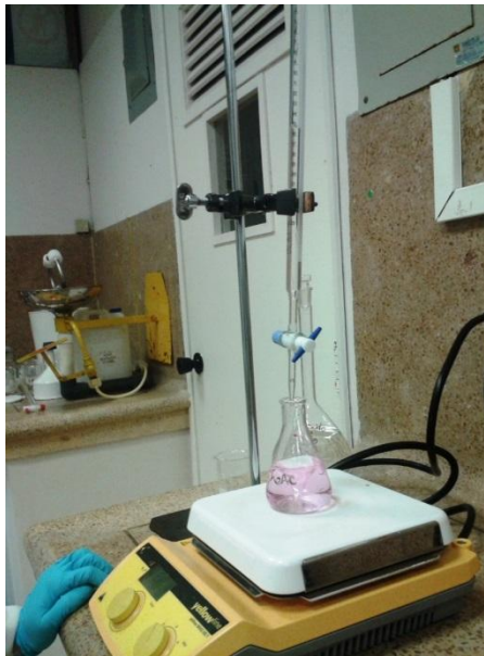
Figura 9 Montaje de la titulación con el hidróxido de sodio a 0,2 N en el análisis de CIC
