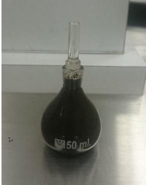
Figura 17 Picnómetro con agua y lodo residual para el análisis de densidad real
