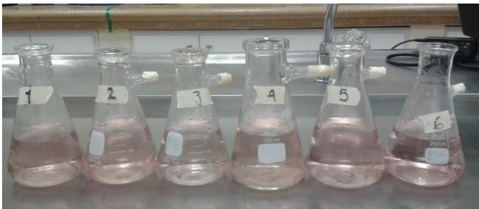
Figura 15 Viraje de las muestras en el análisis de nitrógeno total
