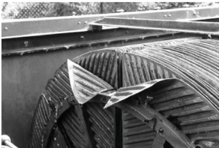
Figura 16. Ejemplo de fallos en los discos por pérdida de rigidez. Tomado de: Mba (2003)
