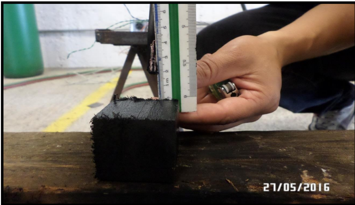
Foto: Fuente Propia, Momento en el que se realiza la graduación del soplete con respecto a la superficie de la madera.
