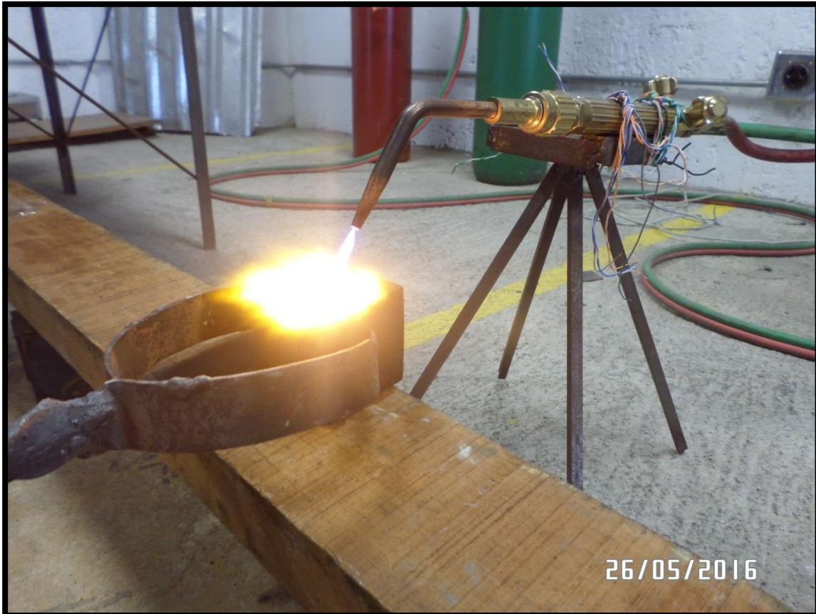
Foto: Fuente Propia, parte del proceso de la prueba donde la probeta es sometida a la llama a 3055°C.
