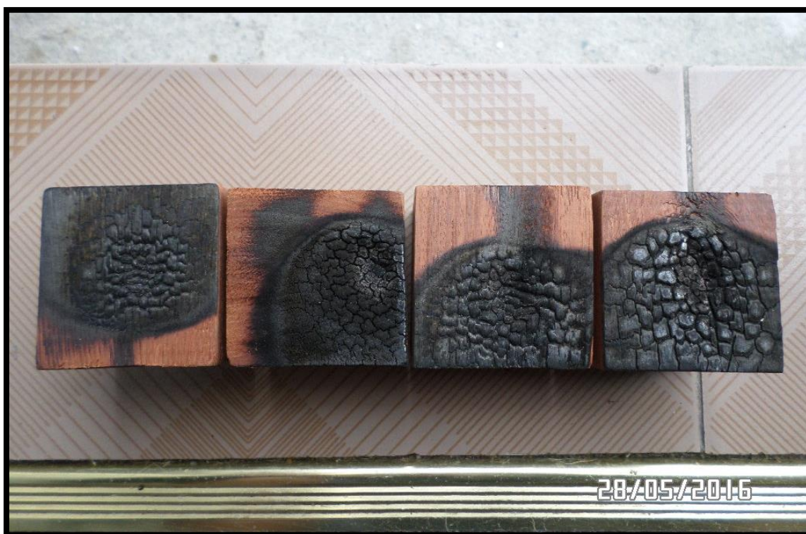
Foto: Fuente Propia, Resultado final de probetas después de la prueba de combustibilidad en estado de humedad relativa natural de la zona de confort y de crecimiento de la madera.
