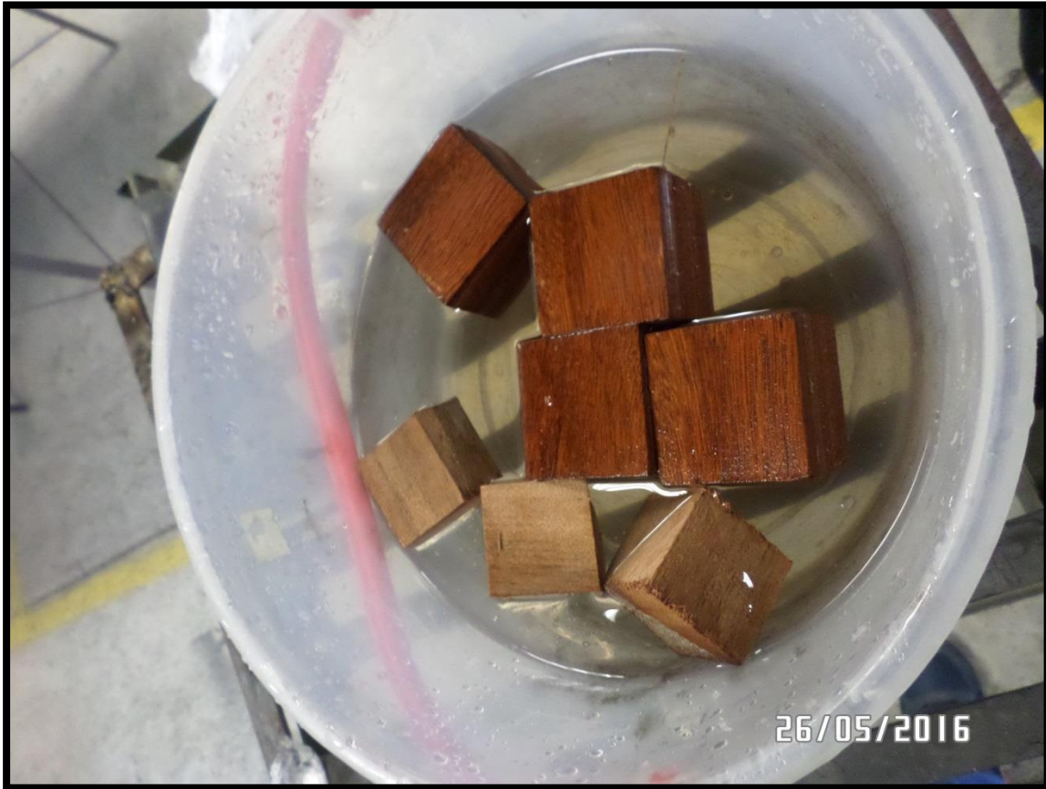
Foto: Fuente Propia, Inmersión de las probetas objeto de estudio en agua.
