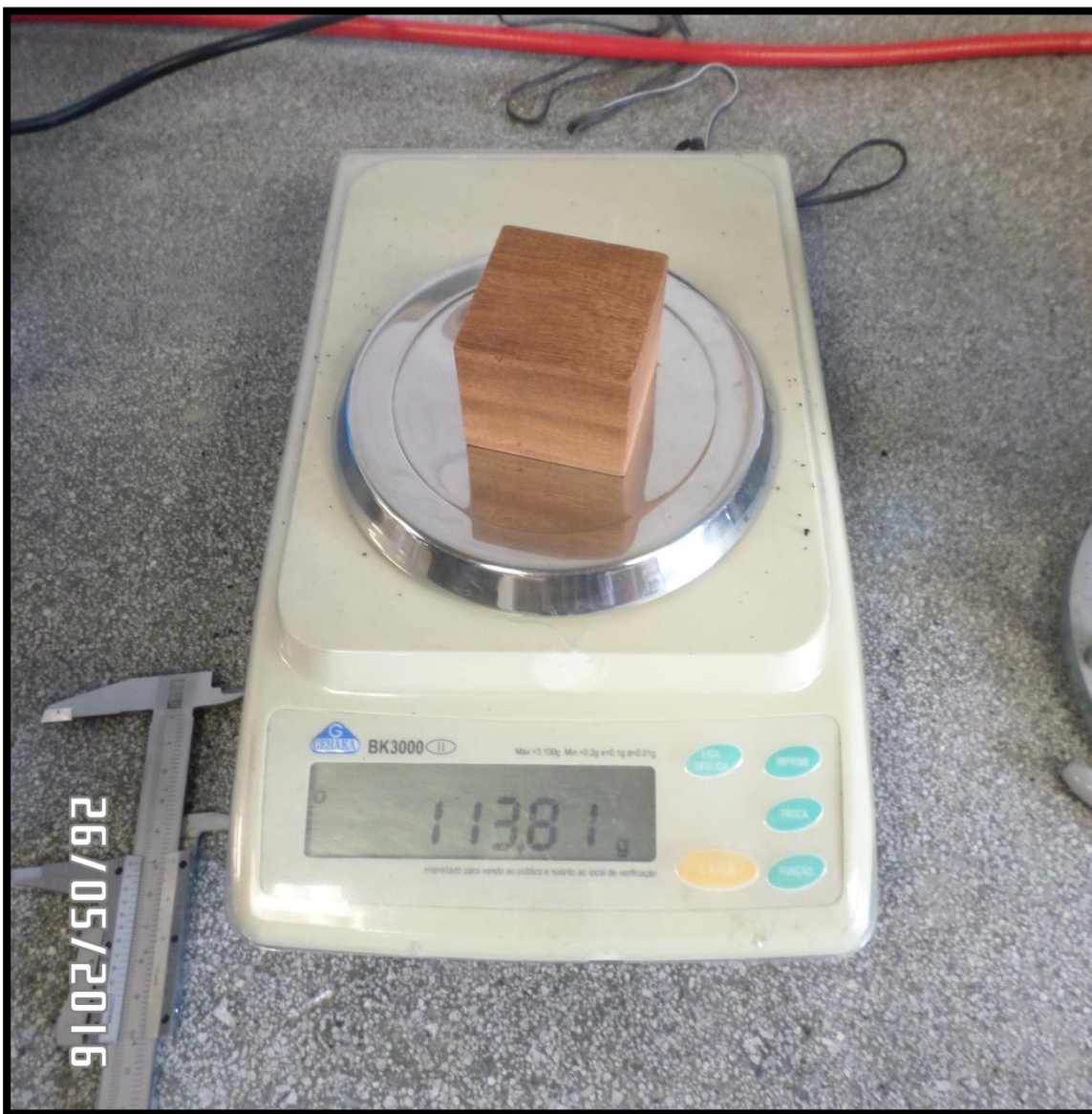
Foto: Fuente Propia, proceso correspondiente a la toma de peso inicial de la probeta.
