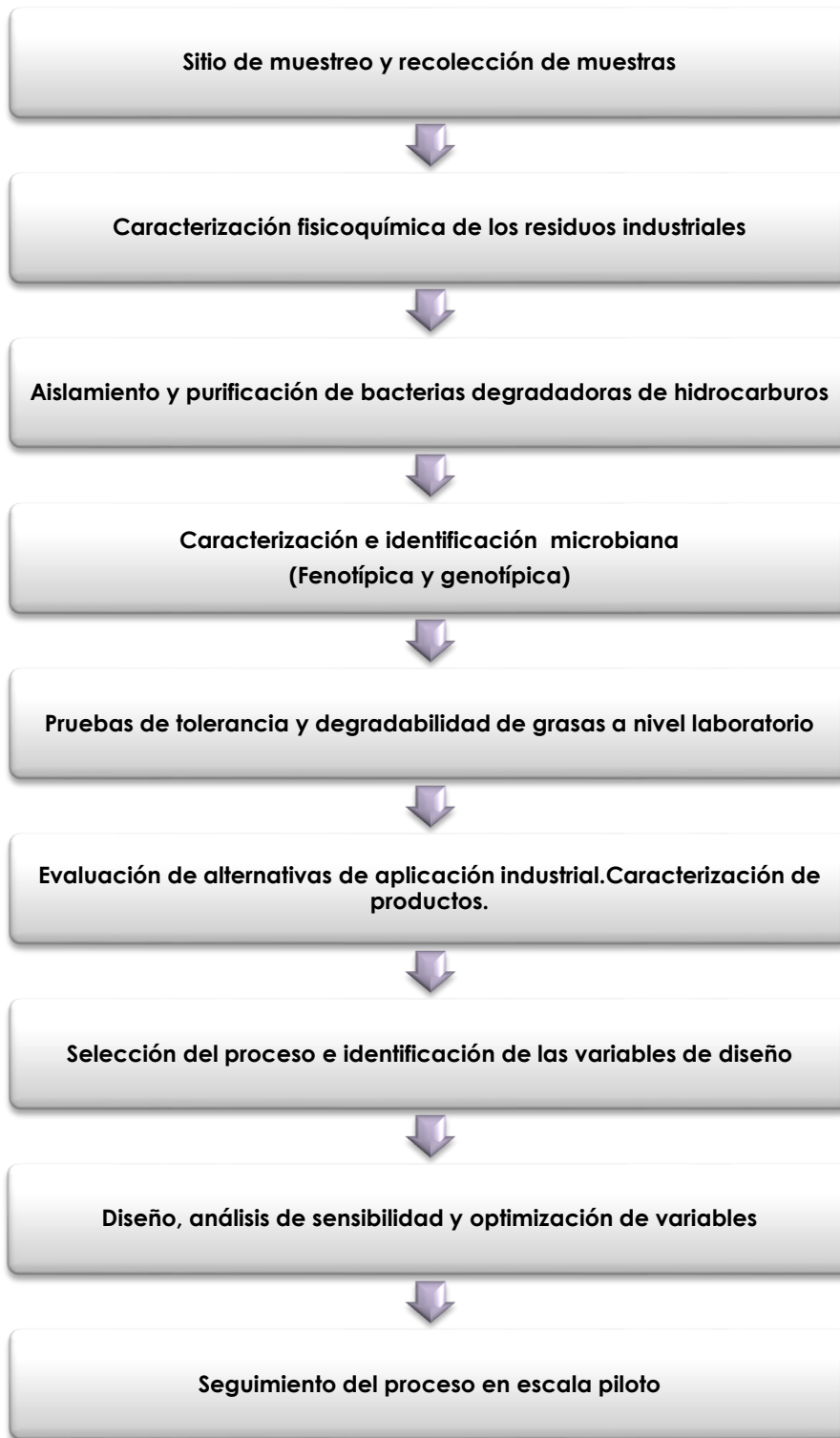
Figura 1.2. Diagrama de flujo para la implementación de un tratamiento de biorremediación de residuos sólidos contaminados con grasas y lubricantes.
