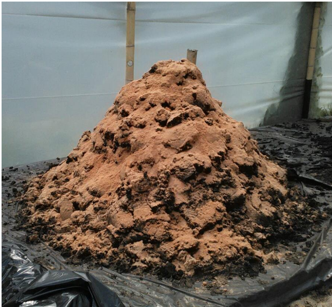
Figura 6. Mezcla de lodo residual y aserrín para obtención de un óptimo equilibrio C/N y nivel de humedad.
