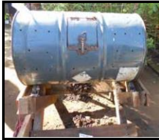
Figura 2. Sistema de compostaje cerrado. Fuente: Manual del compostaje del agricultor, (sf).
