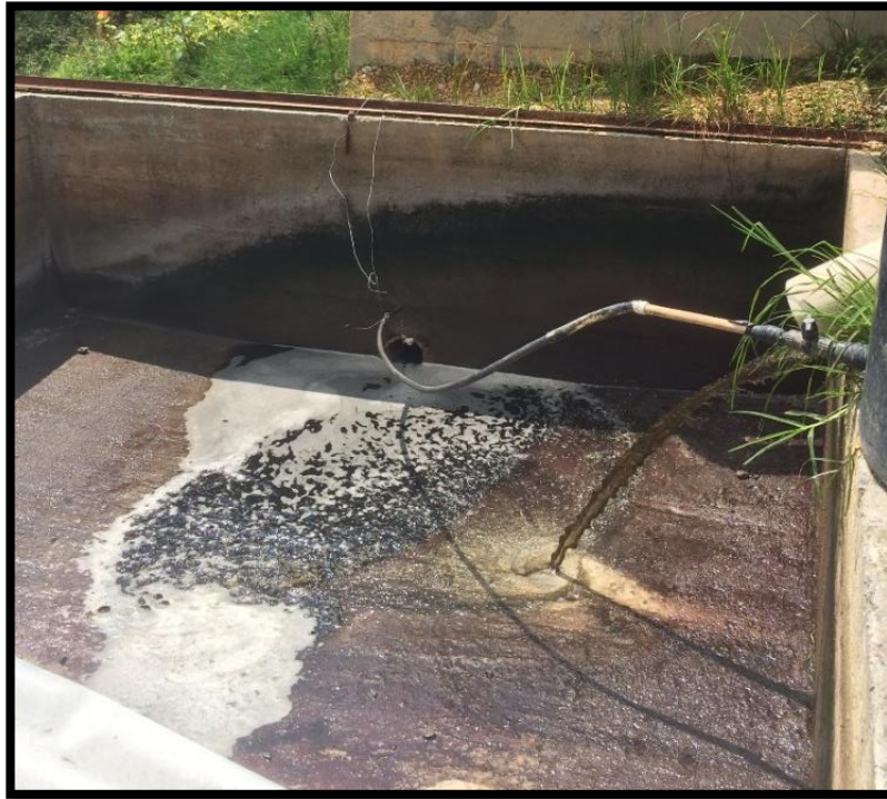
Figura 6: Fotografía de punto de recolección de muestra de lixiviado en el Relleno Sanitario La Esmeralda. Fuente: (Propia).
