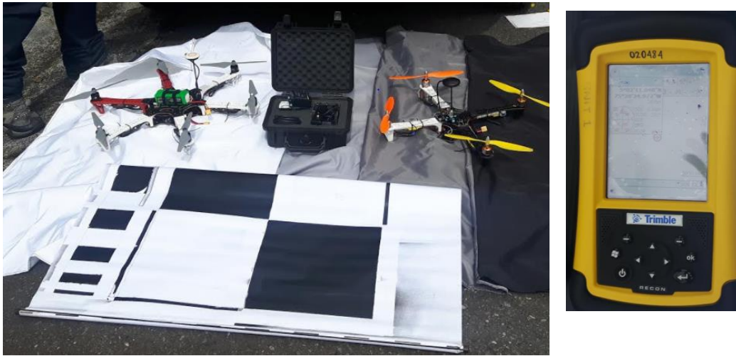
Ilustración 15 Target, RPAS y GPS utilizados en campo.
