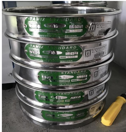
Figura 35. Fotografía del orden y los tamices utilizados en la preparación de la muestra del suelo
