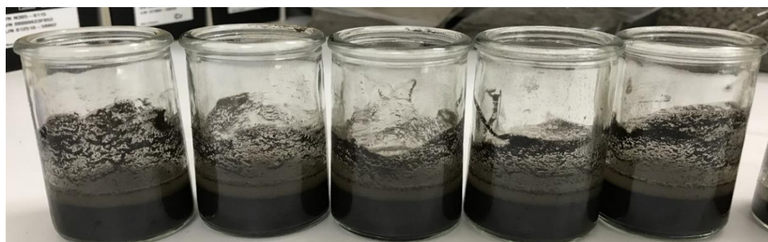
Figura 36. Fotografía que muestra cómo se llevaron a cabo la determinación del PH para los dos suelos en análisis
