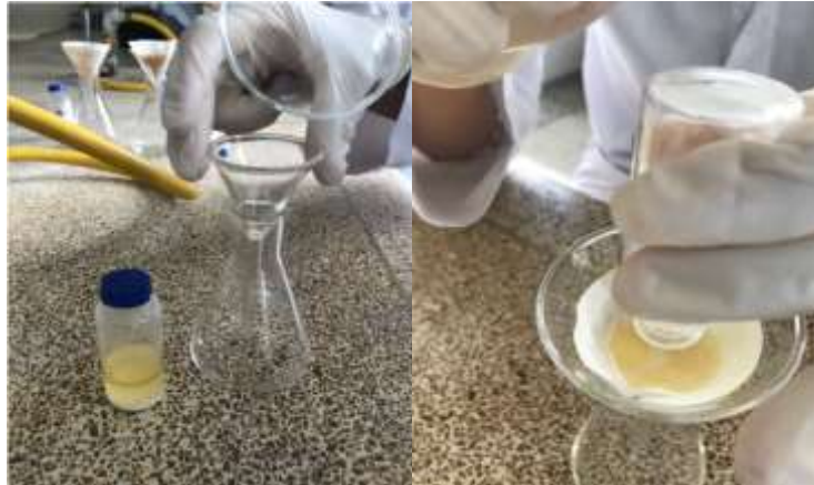
Figura 12. Se evidencia el montaje para iniciar el proceso de filtración de la muestra alcalina a una concentración de 3,34 M.
