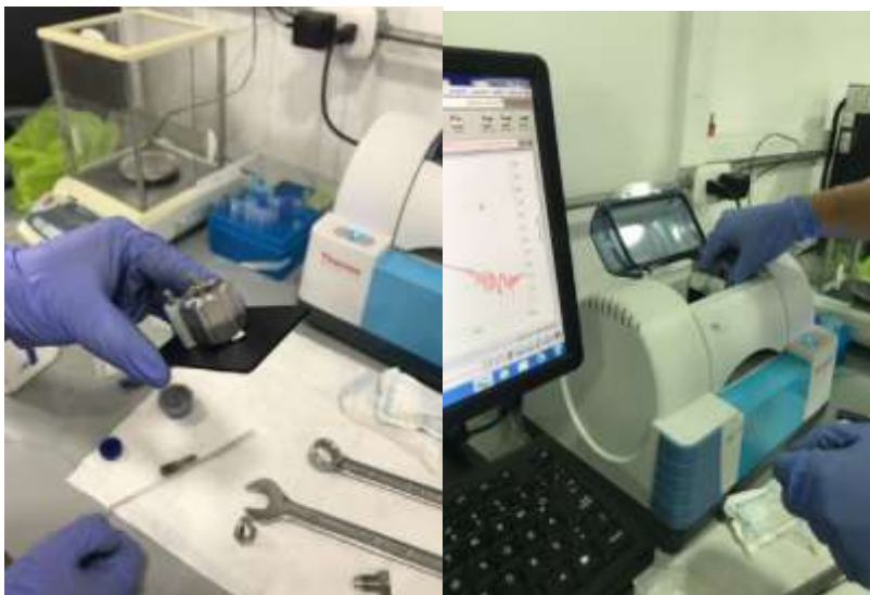
Figura 20. Montaje de la muestra alcalina al equipo de identificación.
