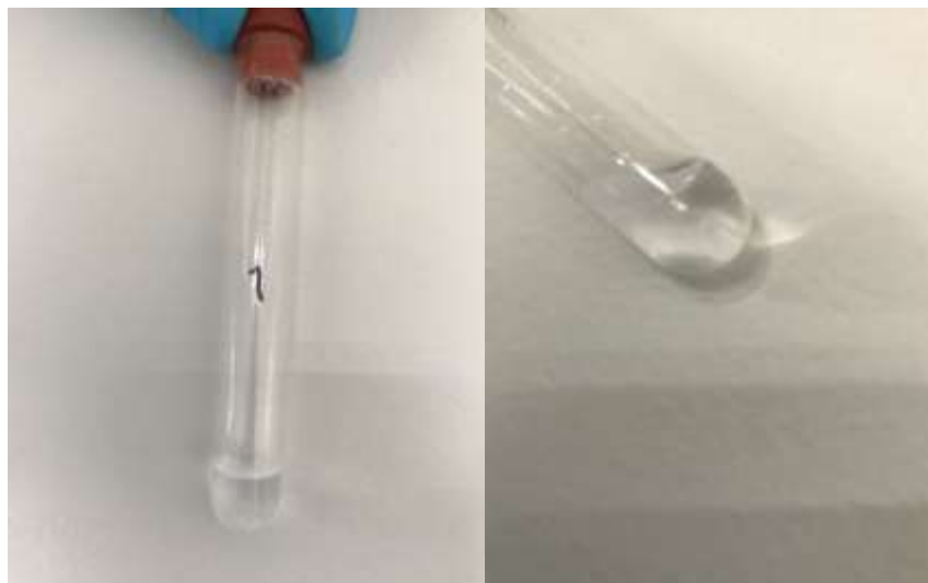
Figura 26. Se observa que hay un precipitado de ácido tereftálico al 98%
