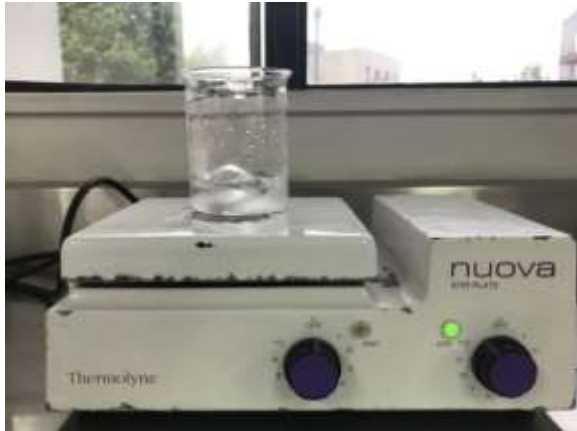
Figura 9. Se evidencia la muestra de ácido sulfúrico reaccionando con 1 gramos de PET sobre una plancha de calentamiento con agitación lenta.
