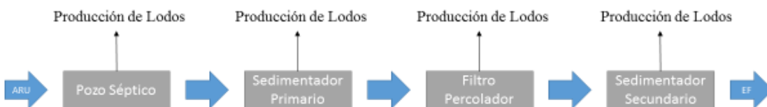
Figura 4. Tren de Tratamiento Filtro Percolador
