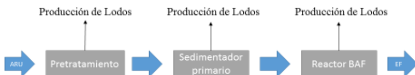
Figura 19. Tren de Tratamiento para Filtro Biológico Aireado.
