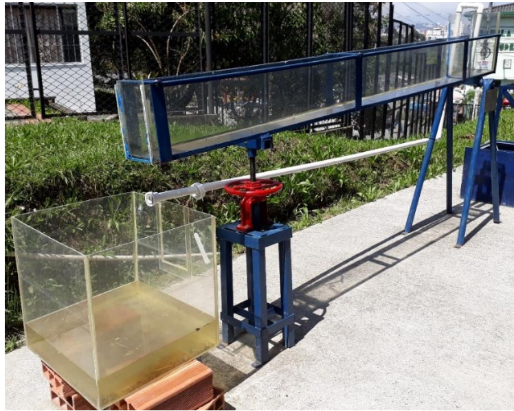
Ilustración 11. Canal de pendiente variable- UNAL Manizales.
