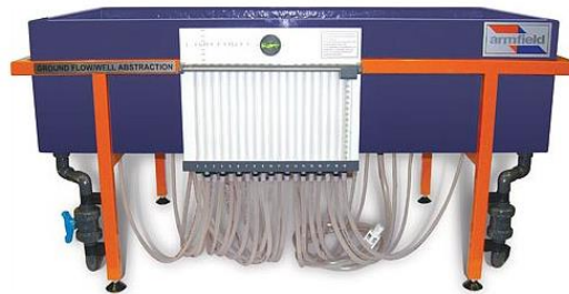
Ilustración 34. Unidad P/Estudiar El Flujo De Aguas Freáticas Armfield – s11
