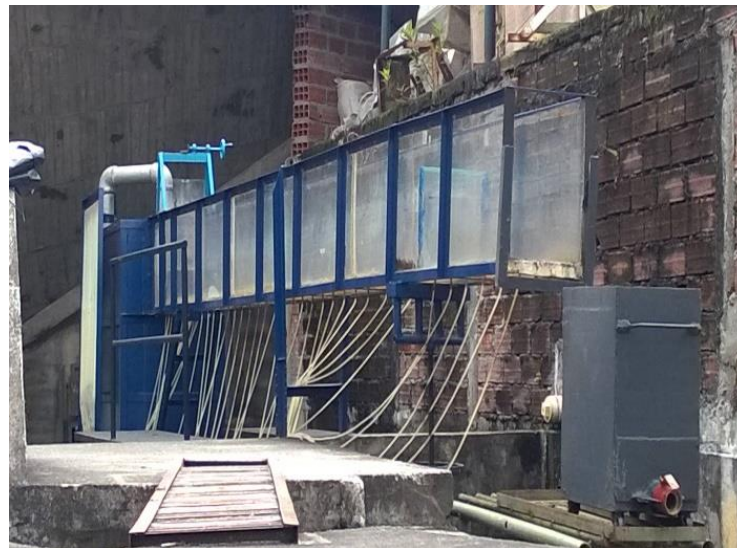
Ilustración 9. Vertedero Hidráulico, Laboratorio de Hidráulica UNAL Manizales.
