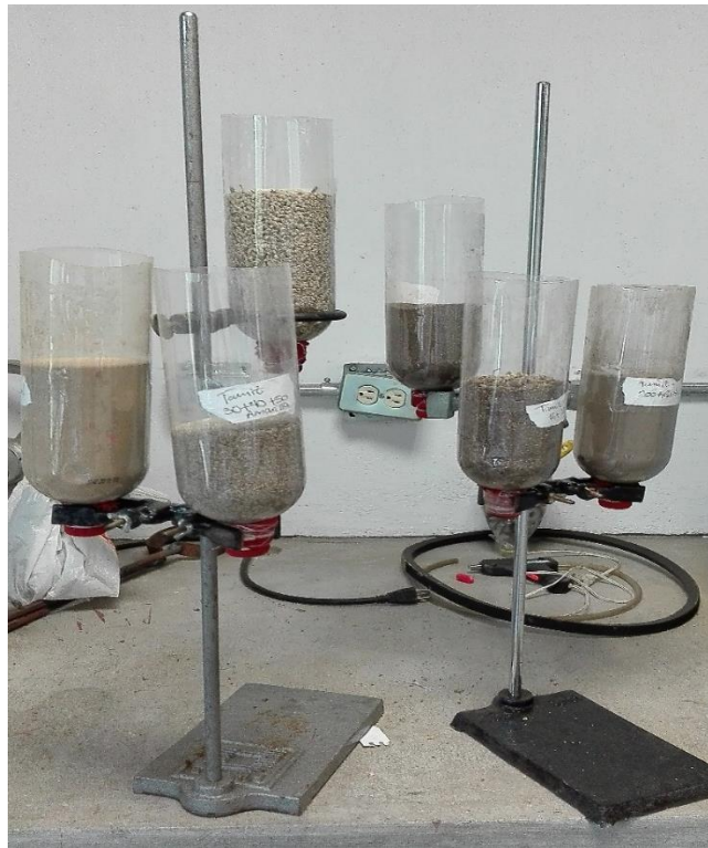
Ilustración 16. Montaje de la prueba de infiltración.
