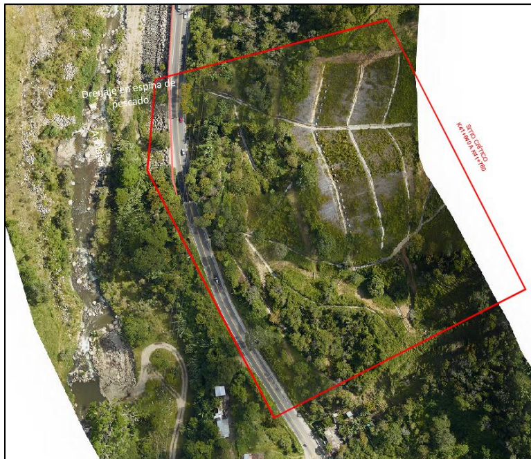
Figura 13. Localización y vista en planta del sitio inestable del sitio crítico 5. (Fuente: Elaboración propia).
