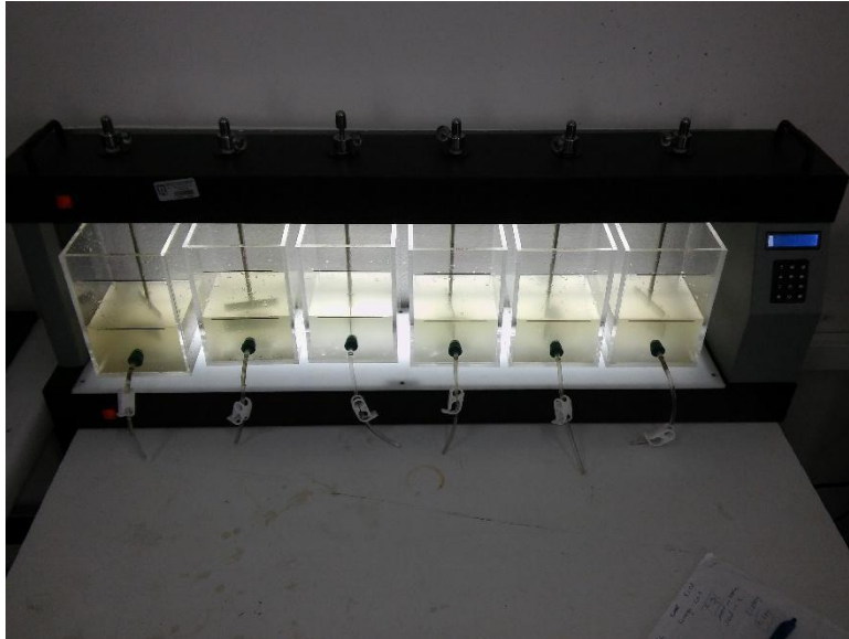
Ilustración 18: Test de Jarras con 1 litro de agua de la quebrada Olivares
