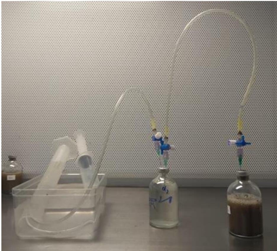
**Figura 5. Montaje de probeta invertida para medición de metano producido en la etapa experimental II.**
