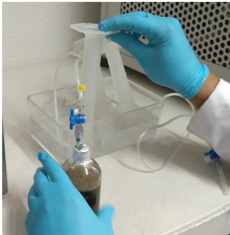
**Figura 4. Medición de gas en la etapa experimental I mediante el método de probeta invertida**
