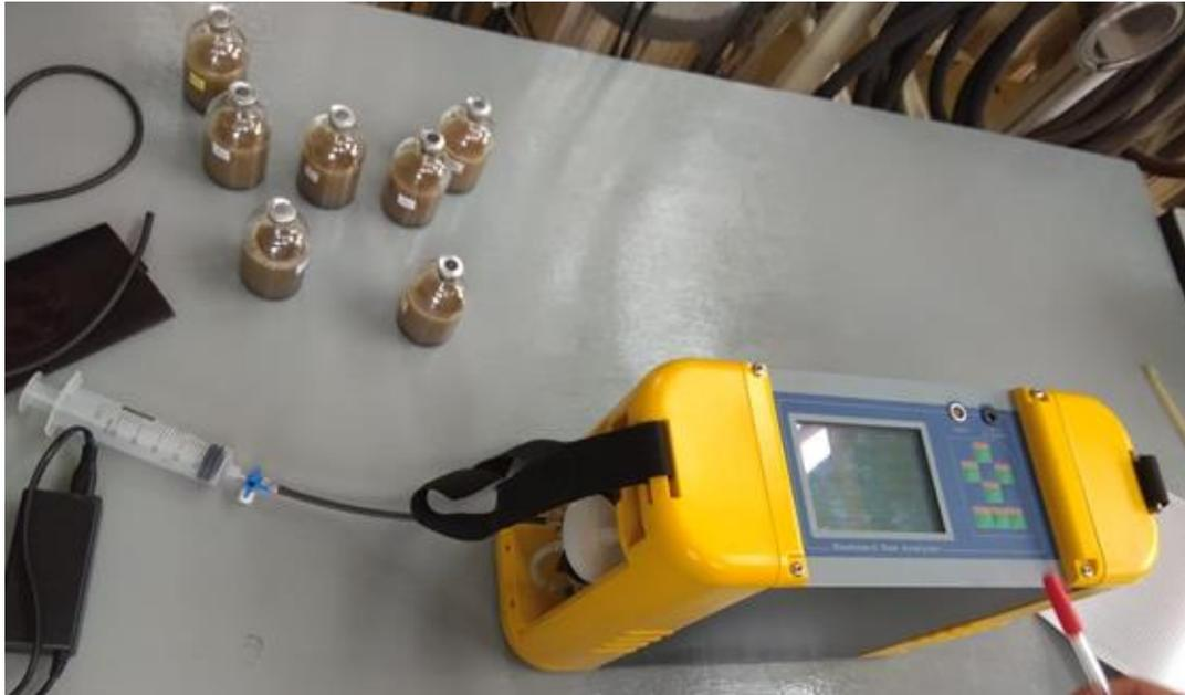
Figura 6. Analizador de gases Gasboard gas Analyzer RS232.
