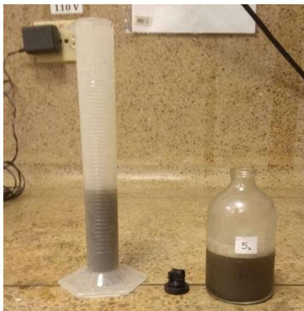
Figura 2. Medición de muestra de los reactores para pruebas finales de sólidos de la etapa experimental II.
