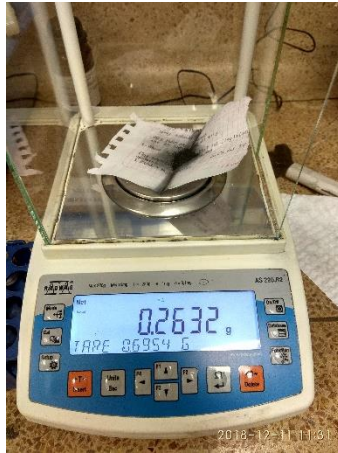
Casallas, A & Sánchez V (2018). Peso del carbón activado (0,26g aproximadamente) [Figura 30]. Elaboración propia
