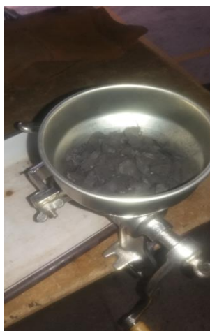
Casallas, A & Sánchez V (2018). Etapa de pulverización del carbón vegetal, [Figura 20]. Elaboración propia.
