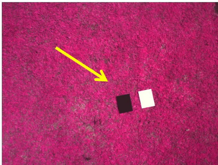
Figura 3.3 Targets de calibración (blanco y negro) sobre una cobertura de grama. Elaboración propia
