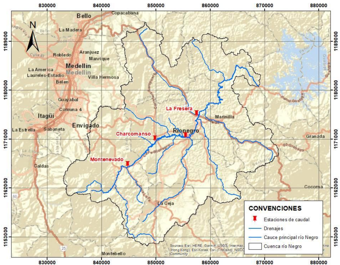
Figura 13. Localización de las estaciones de caudal ubicadas al interior del cauce principal del río Negro
