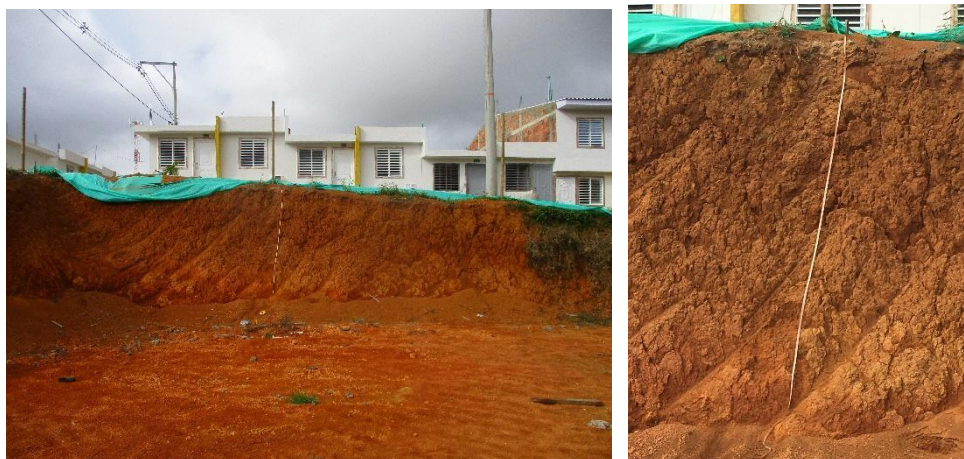
Figura 15. Afloramiento, de suelos residuales de basaltos en zona de adecuación urbana, ubicada en la Carrera 14 Calle 17. Fuente: Elaboración propia
