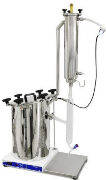
Figura 6: Extractor de aceites esenciales por arrastre de vapor con capacidad para almacenar 25 L de materia prima
