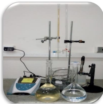
Gráfica 4. Montaje para la síntesis por el método de coprecipitación de los HDL. sal sulfatada [izquierda], hidróxido de sodio [derecha]
