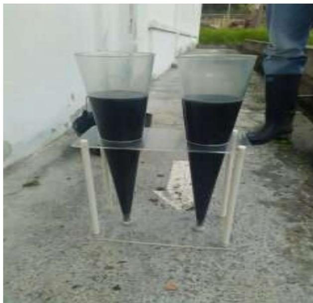
**Figura 41. Muestras del lixiviado estabilizado recolectado**
