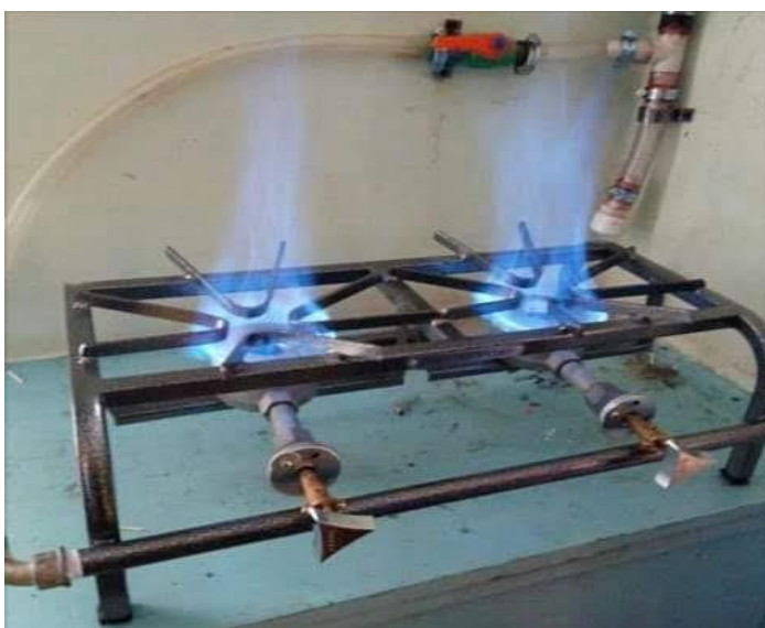
Figura No. 27: Prueba de producción de biogás
