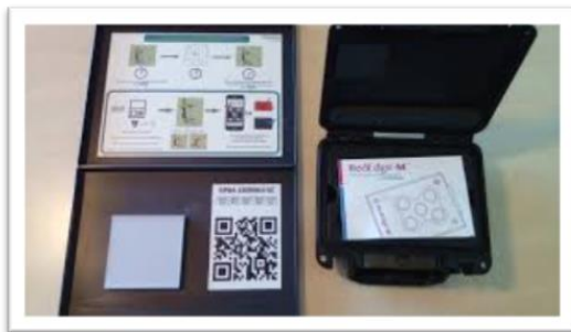
Figura 19 . Panel de calibración suministrado por MicaSense para el sensor RedEdge
