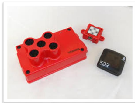
Figura 13. Sensor Micasense RedEdge. GPS y Sensor de iluminación.
