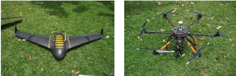
Figura 1. Tipos de plataformas RPAS: (A) Tipo Ala Fija (B) Tipo Multirrotor
