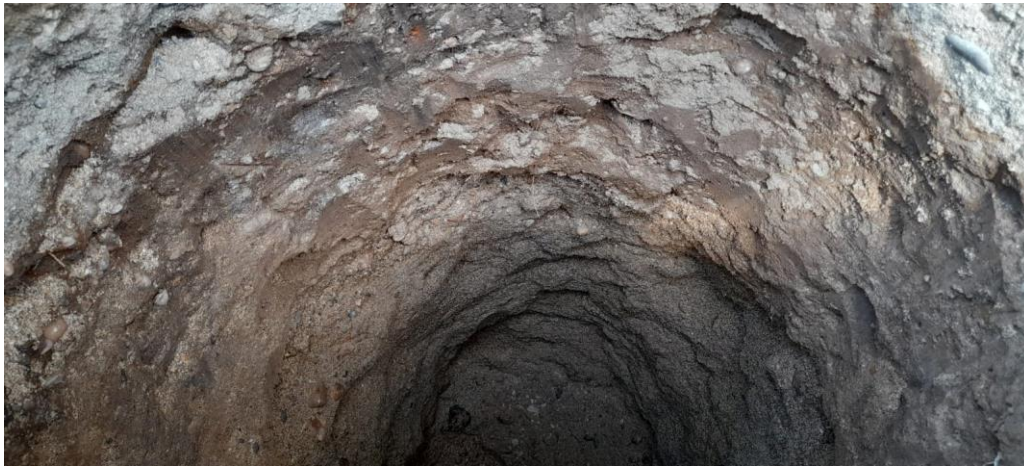
Imagen 9. Apiques para descripción sedimentaria, toma de muestras para análisis granulométrico y capacidad portante de los suelos en área de influencia del proyecto de mitigación de socavación.
