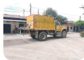
Humectación de vías
