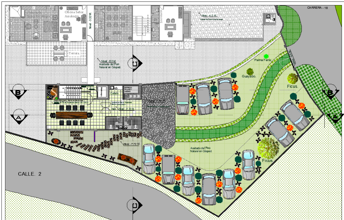
Imagen 76. Ampliación Vivienda Arzobispal Planta Nivel -7,72 m.
