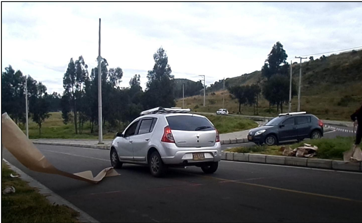
Nota. En la figura se observa las pruebas de velocidad a 30 km/h, sin que queden huellas de frenada
