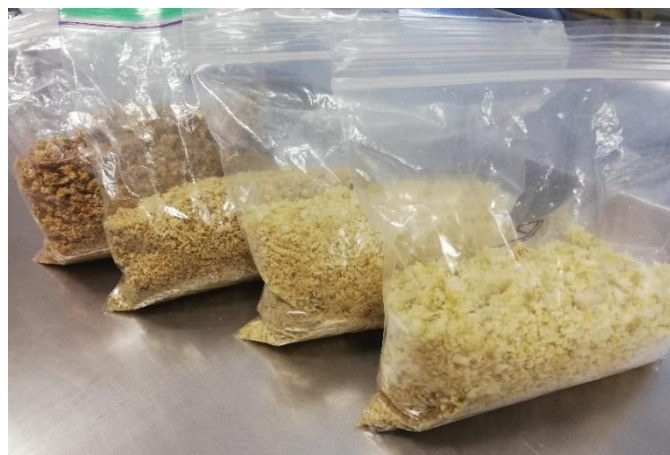
Ilustración 10. Evidencia de empaque de las muestras con pretratamiento hidrotérmico de 30, 50, 70°C y Raw, para ser llevadas a análisis elementales como de toxicidad.
