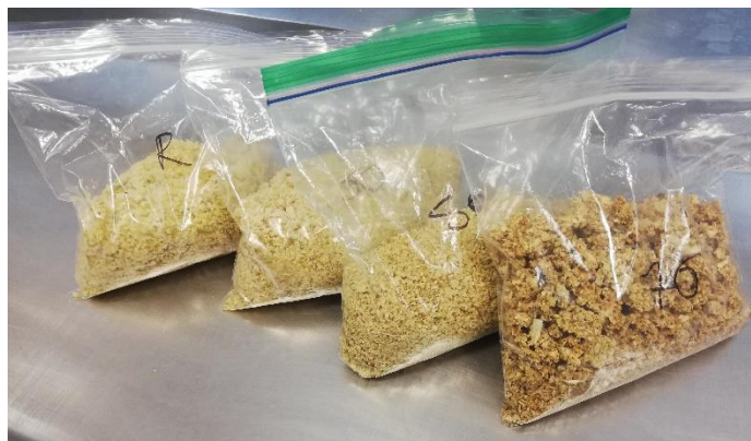
Ilustración 6. Evidencia de secado de la cáscara de naranja a 30, 50, 70°C y Raw.
