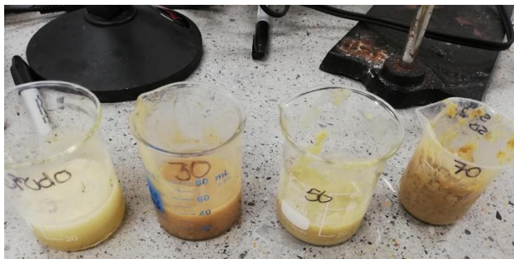
Ilustración 9. Evidencia de la separación de fase sólida y fase soluble de las muestras con pretratamiento hidrotérmico de 30, 50, 70°C y Raw.
