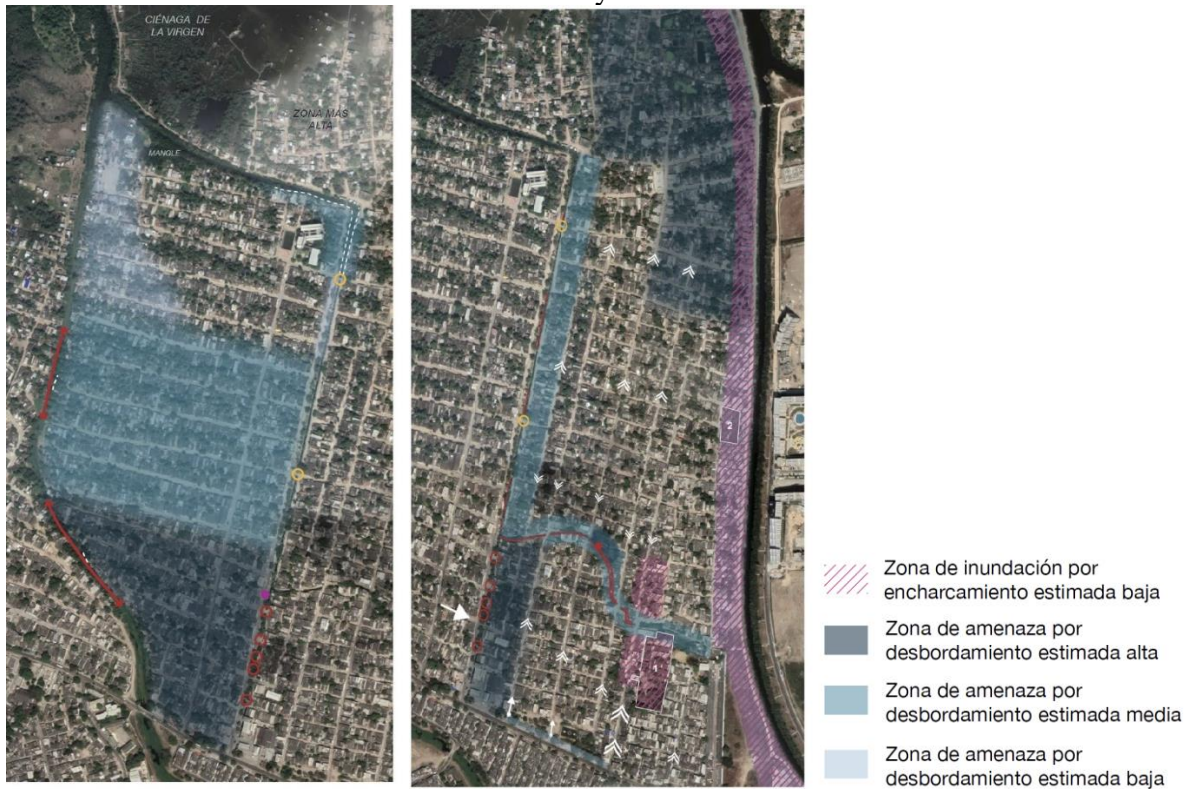
Figura 14. Mapa Estimativo de la Amenaza por Desbordamiento de Cuerpos de Agua Barrio Fredonia y Nuevo Paraíso
