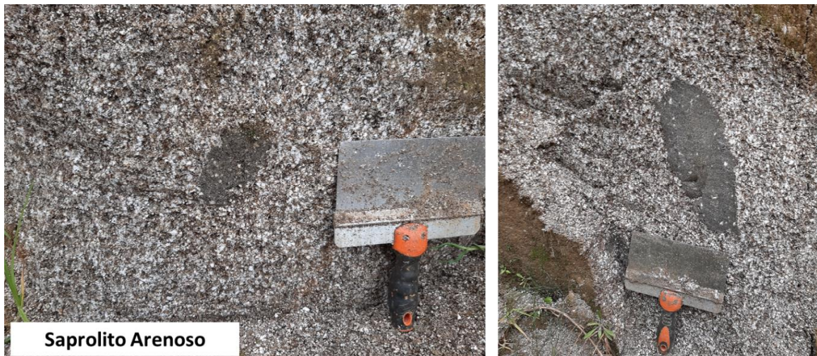
Figura 18. Saprolito arenoso del Batolito Antioqueño en la base de la Cárcava El Carmelo.
