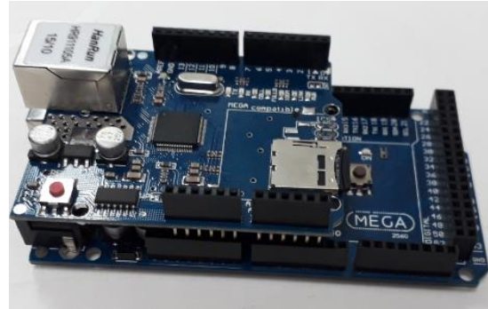
Ethernet shield sobre el arduino mega 2560
