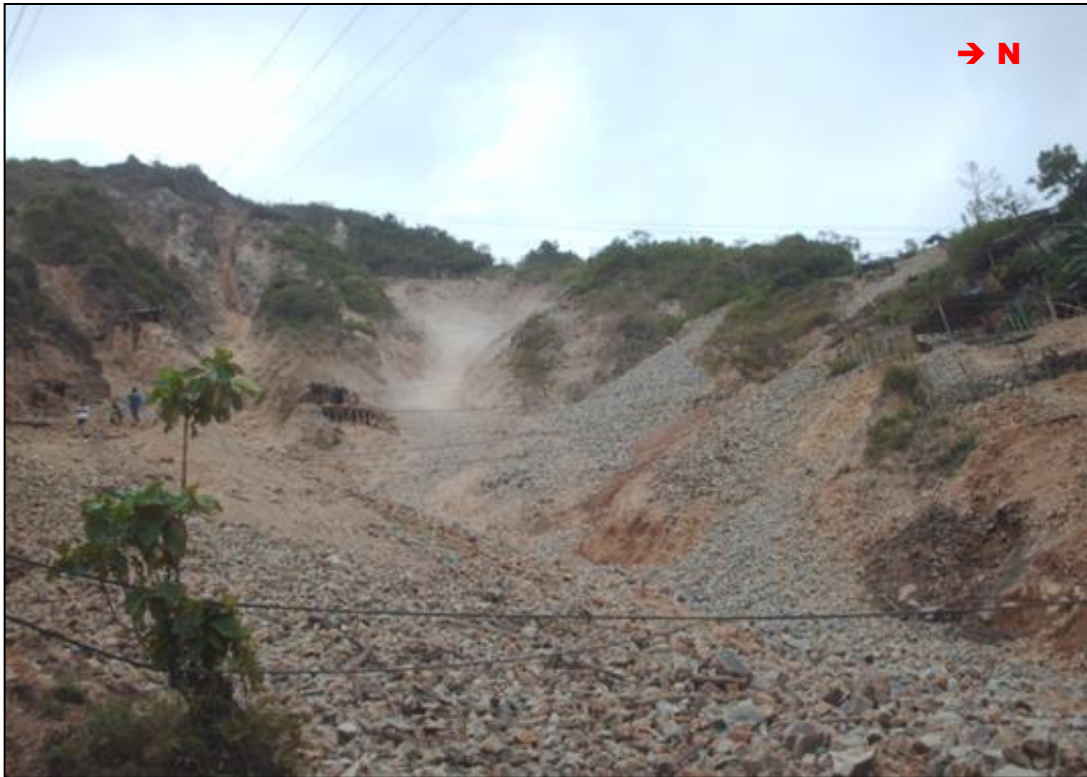
Fotografía 8. Momento en el que material estéril es arrojado desde la parte superior del Canalón de la Iglesia, sin ningún control. Fuente propia. 2012.
