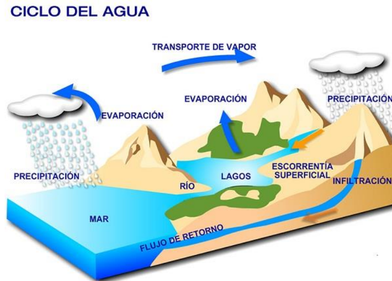
Figura 3: La presente imagen nos indica brevemente el ciclo del agua en donde se puede visualizar la escorrentía superficial que cae a los lagos y ríos de un territorio para que después la evaporación del agua convierta estas partículas nuevamente en precipitación en los mares y zonas de recarga hídrica en las montañas. (Eoearth, 2010)
