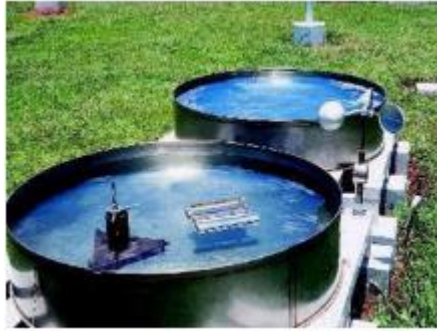
Figura 9: El tanque de evaporación se instala en un lugar abierto, de radio no menor a 50 m. A su alrededor está cubierto por césped, mantenido por medio de cortes frecuentes a 5 cm de altura. (Ordoñez, 2011)
