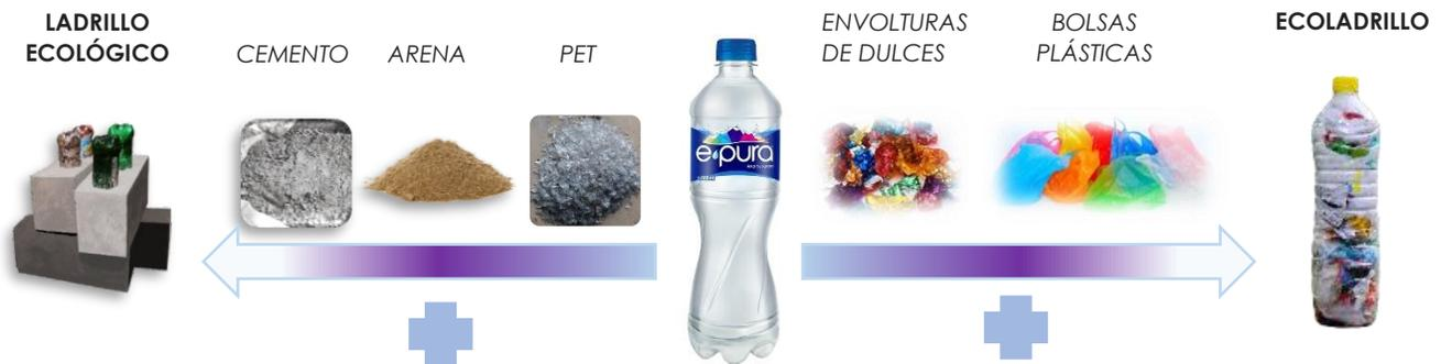
*¿Es posible desarrollar un ladrillo combinado con Eco ladrillo y concreto con partículas de Pet que iguale o supere las propiedades de Resistencia de ladrillos convencionales de Arcilla y Concreto que tienen uso no estructural?*
