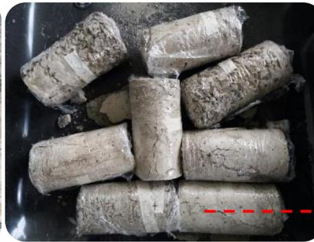
Cilindros de pruebas después de ser sometidos al esfuerzo de compresión.
