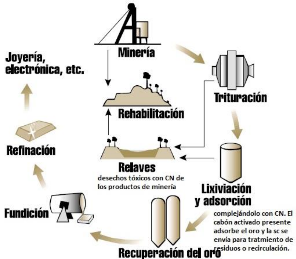
Figura 1. Procesos productivos para la obtención del oro. Fuente: Seferian (2008).
