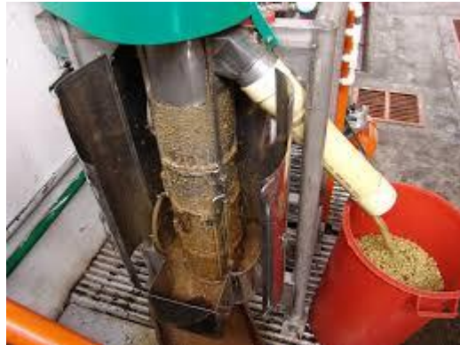
Figura 3. Proceso de desmucilaginado del café
