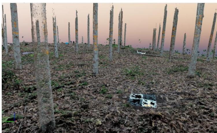
Figura 13 Generación de nube de puntos fotogrametría terrestre
