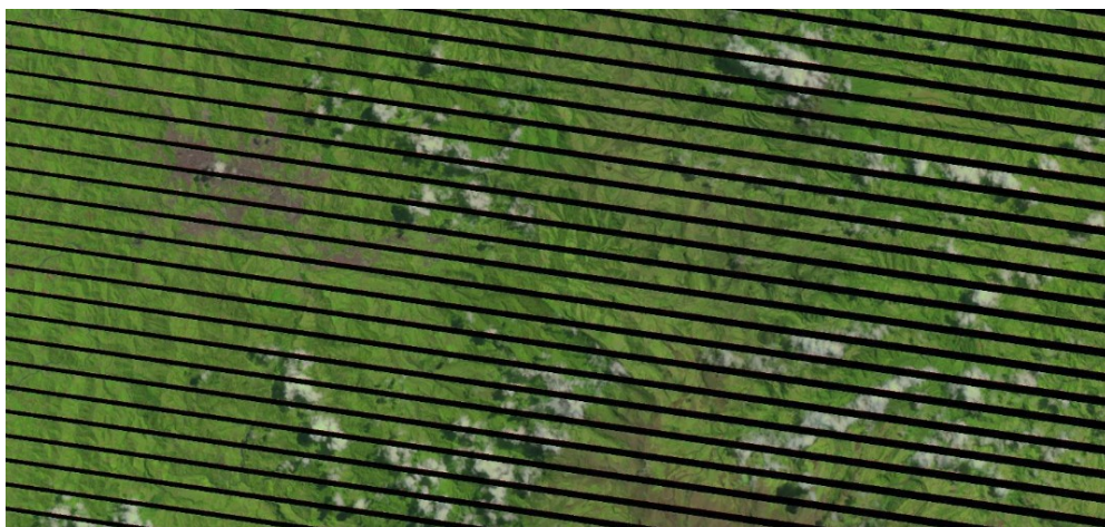
Ilustración 18. Error de bandeado de imagen Landsat 7. Autoría Propia
