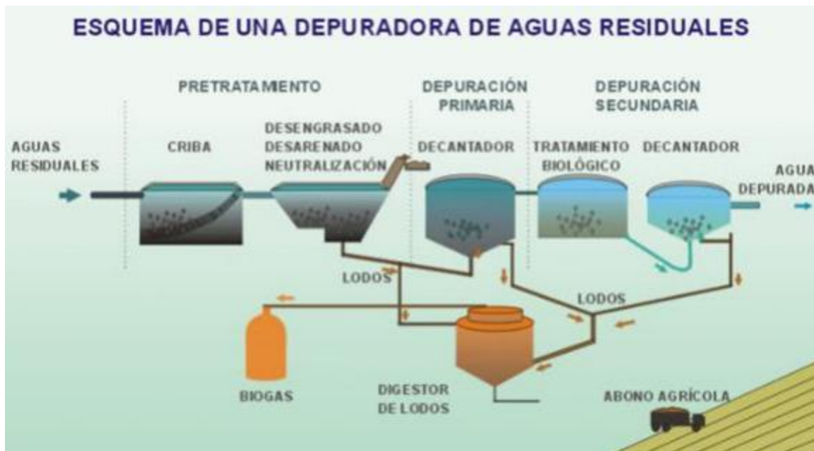
Figura 3. Esquema de una depuradora de aguas residuales.
