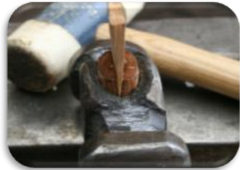
Ilustración 38 Cuña del Martillo Oblicuamente (MAL)
