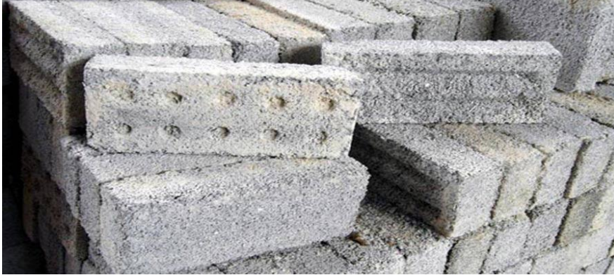
Imagen 7: prototipo de ecoladrillo con base en material PET
