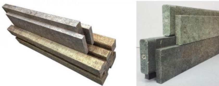
Imagen 6: de prototipo de ecoladrillo en forma de legos para ser más eficiente en el momento de una construcción con base en material PET
