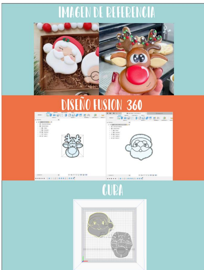
Figura 12. Proceso imagen de referencia diseño en Fusion 360 y Cura.
