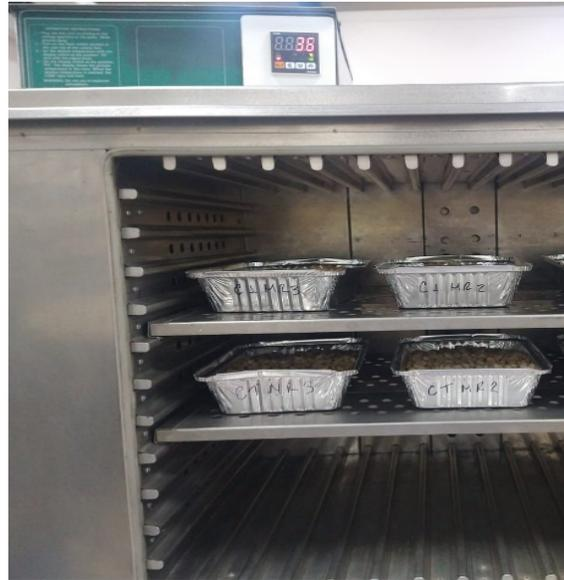
La mitad de las muestras de cada tipo de café se dejaron secando 8 horas para alcanzar un nivel de humedad alto, la otra mitad se dejó 22 horas para alcanzar un nivel de humedad bajo. Estas muestras se empaican en bolsas plásticas con cierre hermético, se marcan con la misma nomenclatura que las bandejas, y se guardan en un desecador por 72 horas:
