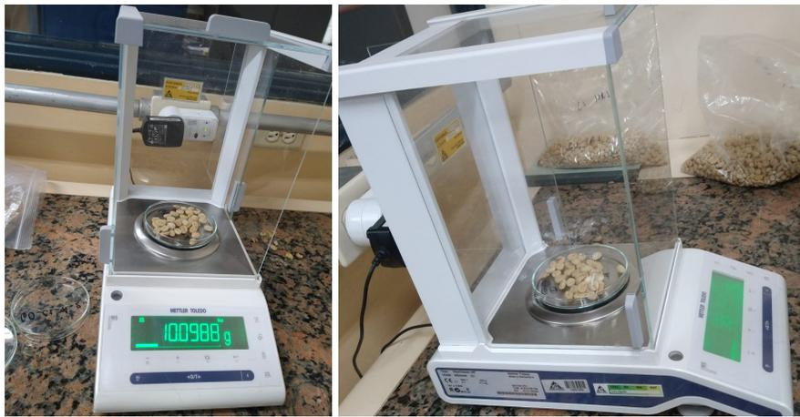
Al finalizar las mediciones, se llevan las cajas al horno programado a 105 °C durante 16 horas. Pasado este tiempo, se sacan las cajas usando una pinza para crisol y se introducen nuevamente en el desecador por 1 hora, permitiendo que alcancen la temperatura ambiente. Posteriormente, con la balanza se mide el peso de la caja con la muestra de café y se registran estos datos en la columna M2 de la tabla 5.
