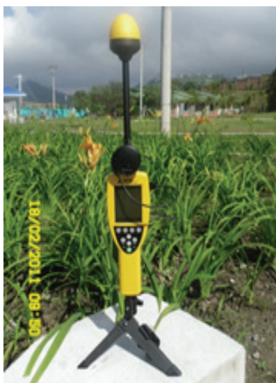
Figura 29. Equipo de medición NARDA NBM-550, con la sonda de 100KHz – 3GHz y en la parte frontal el GPS GARMIN Fuente: elaboración propia.
