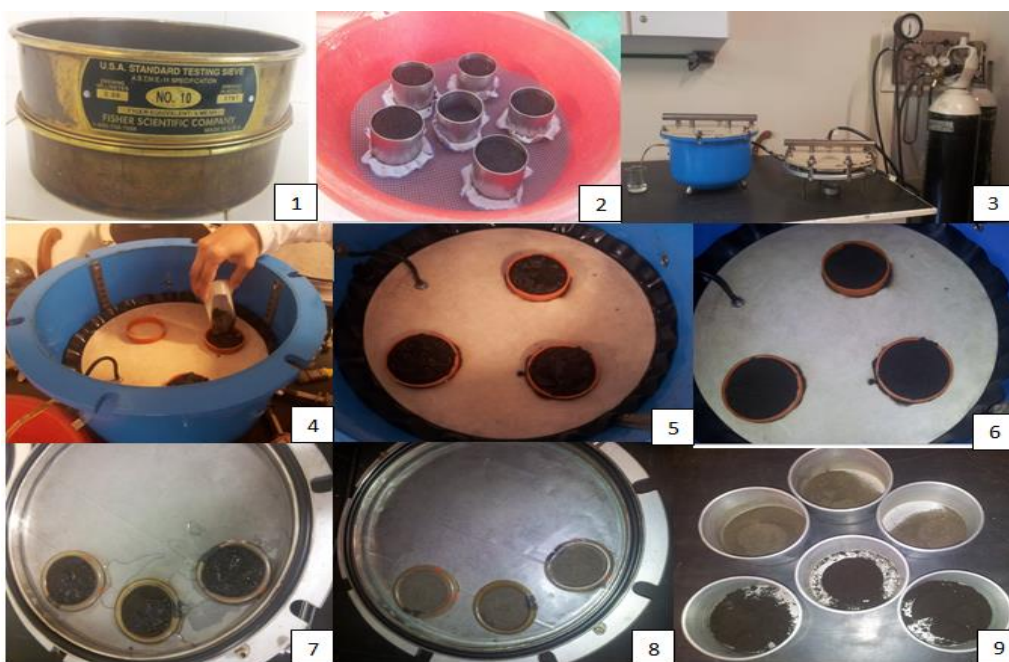
Figura 2. Montaje para obtención de puntos de retención de humedad del suelo.
