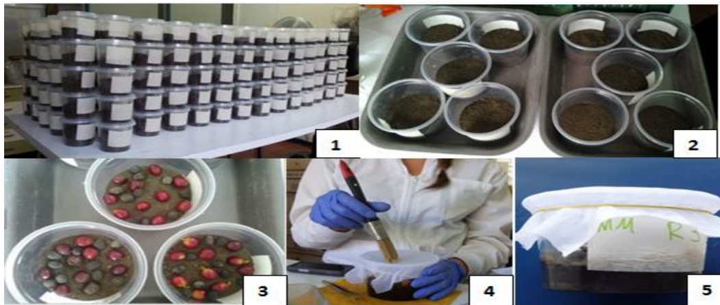
Figura 3. Preparación de Unidades experimentales. 1- Preparaciones de tarrinas con el suelo. 2- Cubrimiento de la tarrina con muselina. 3- Tarrina lista para almacenamiento.
